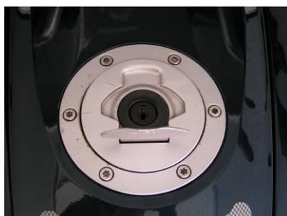
4. Déposer l'élément de carénage au dessus du réservoir. Pas besoin de déposer les flancs du carénage. Dévisser les 6 vis de fixation des éléments latéraux sur le réservoir et les 2 vis situées sous la selle. Soulever les flancs du carénage pour sortir le dessus du réservoir.
