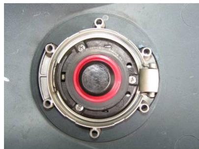
6. Remonter l'élément de carénage et le bouchon de remplissage en prenant soin de remplacer le joint torique comme indiqué dans la partie précédente.
