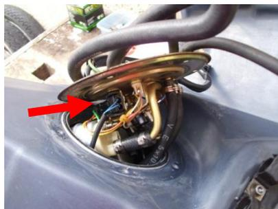
Aligner le repère sur le réservoir avec le méplat de la platine (Flèche verte).
