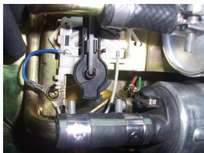
Vérifier que les vis des colliers ne viennent pas en contact avec le mécanisme de la jauge et les connections électriques de la pompe à essence.
