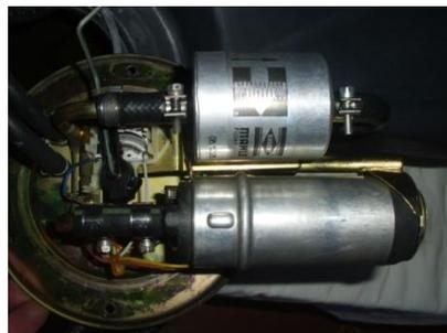
Inséré la nouvelle pompe dans la durite mettre l'amortisseur de vibrations noir et insérer le tout dans le support métallique et serrer les 2 colliers sur la durite.
