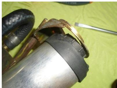
Installé une nouvelle durite avec ses 2 colliers de serrage dans le tuyau coudé fixé sur la platine.
