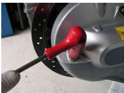
6. Enlever le bouchon de vidange puis dévisser entièrement le bouchon de remplissage et laisser s'écouler toute l'huile du couple conique.
