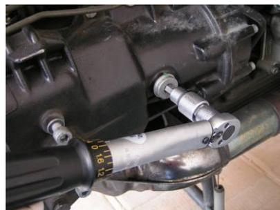
16. Vérifier l'absence de fuite puis remonter le flanc du carénage et la platine repose pied si besoin. Faire un essai sur route et revérifier le niveau d'huile.
