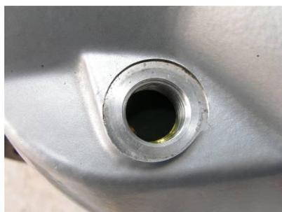
10. Remonter le bouchon de remplissage muni d'un joint neuf, en prenant soin de bien nettoyer la surface d'appui de son joint sur le carter de boîte avec un chiffon.
