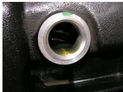
14. Remonter le bouchon de remplissage muni d'un joint neuf, en prenant soin de bien nettoyer la surface d'appui de son joint sur le carter de boite avec un chiffon.
