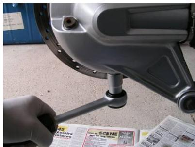
7. Remonter le bouchon de vidange avec un joint neuf, en prenant soin de bien nettoyer la surface d'appui de son joint sur le carter de boîte avec un chiffon.
