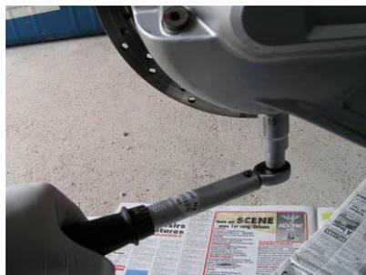
8. Serrer le bouchon de vidange avec la clé dynamométrique (Couple de serrage 23Nm).
