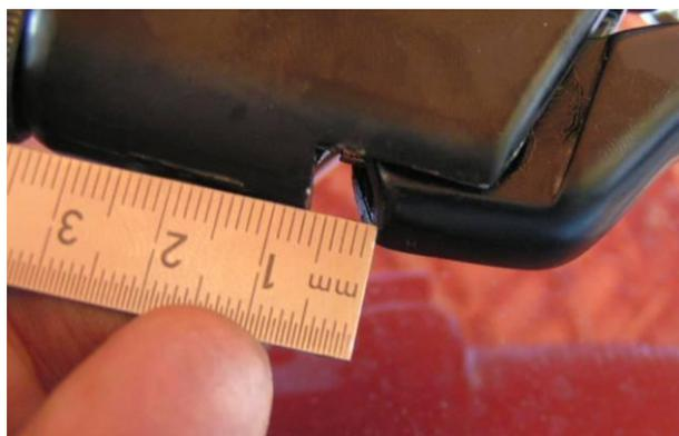
Une fois le réglage obtenu serrer le contre écrou de la biellette en maintenant la vis de butée immobile. J'ai utilisé une clé plate de 13 et une clé à tube de 10. J'ai ensuite bloqué le contre écrou à l'aide de la clé à cliquet et du montage décrit précédemment. Serrage final avec la clé dynamométrique (Couple de serrage à 22Nm).
