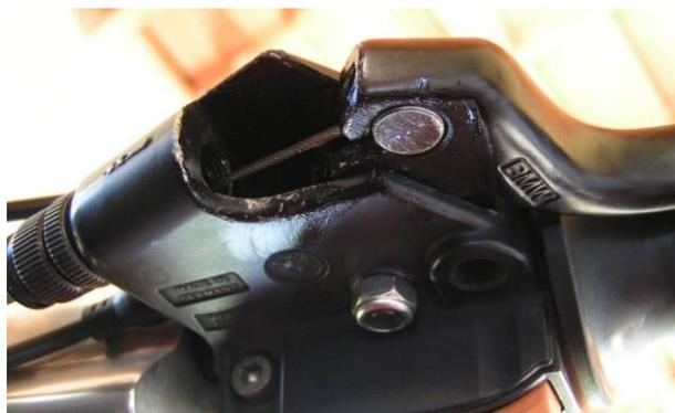
Passer la gaine dans le guide câble situé derrière le tube d'admission du boîtier papillon droit. J'ai fait passer le câble derrière les durites de freins (Cercle rouge sur la photo), le cheminement me paraissait plus naturel.
