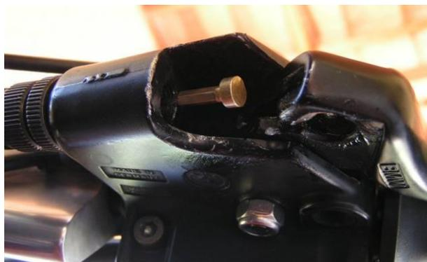
Monter le pivot dans l'embout serti et le mettre dans le levier en ayant pris soin de graisser l'ensemble pour assurer une bonne rotation du pivot dans le levier. Ce point est très important pour assurer une bonne longévité du câble.
