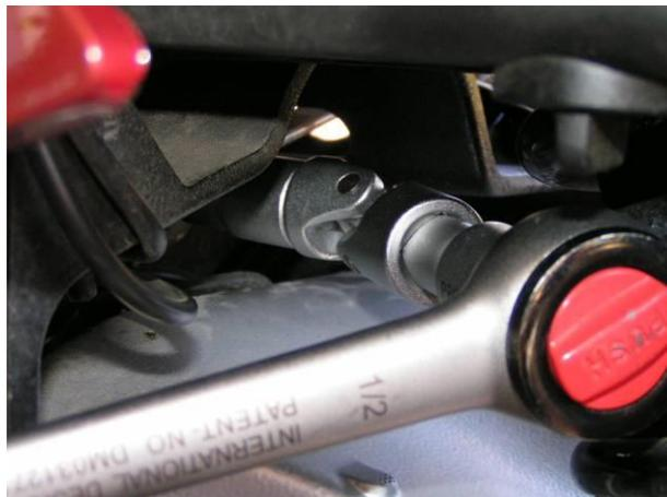
Une fois le câble correctement fixé aux deux extrémités, il reste à régler la garde. Régler le tendeur pour obtenir un entraxe de 12 mm en l'écrou et le contre écrou (Cote "A" sur le manuel BMW). Mettre le cache caoutchouc en place sur le tendeur. Ajuster la vis de butée de la biellette d'embrayage pour obtenir un jeu de 7mm au levier d'embrayage (Cote "B" sur le manuel BMW). Actionner le levier d'embrayage à chaque réglage de la vis de butée.
