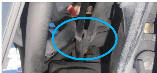
Pour démonter le câble il faut sortir l'arrêt de câble de la biellette puis la gaine du guide câble situé derrière le tube d'admission du boîtier papillon droit que j'ai démonté pour faciliter l'accès.
