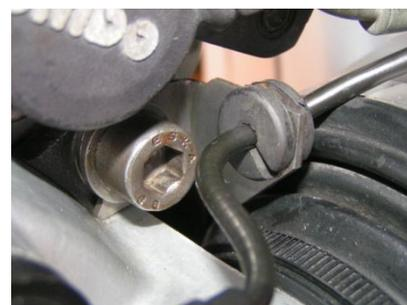
4. Sortir le câble du capteur du guide câble en caoutchouc
