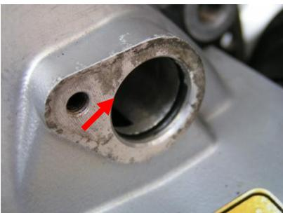
12. Remonter le capteur ABS avec les calles d'épaisseur et la vis de fixation (Torx 25).
