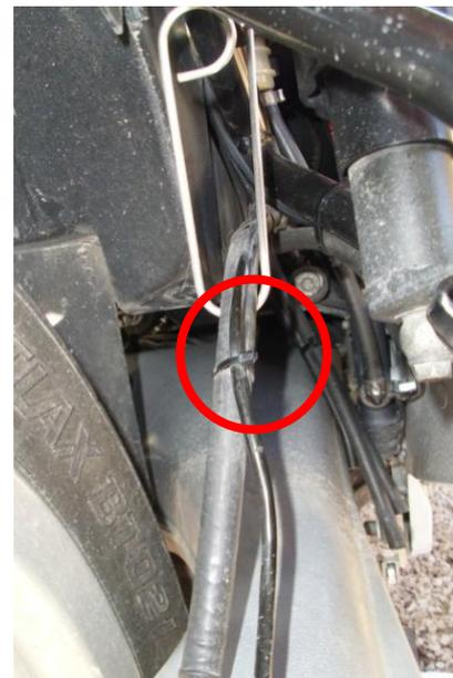
10. Débrancher le connecteur du Capteur ABS situé sur le côté droit de la moto juste sous l'élément de carénage arrière.
