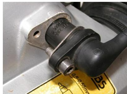
13. Vérifier l'entrefer entre le capteur ABS et la couronne à l'aide d'un jeu de calle d'épaisseur. L'écartement doit être de 0,50mm au point le plus éloigné. Ce point est marqué par une touche de peinture sur la tranche de la couronne.
