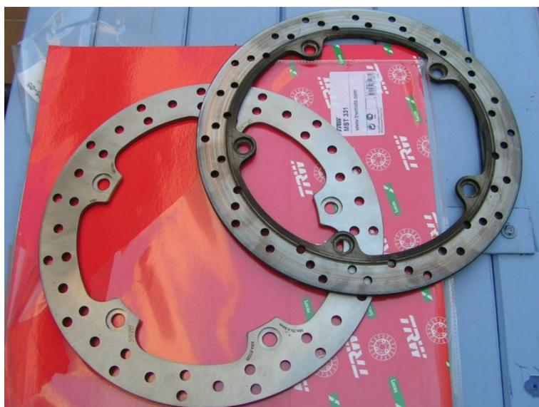
Le disque neuf et l'ancien. Le neuf est plus joli, non ? J'ai pris des mesures d'épaisseur pour voir le niveau d'usure :
