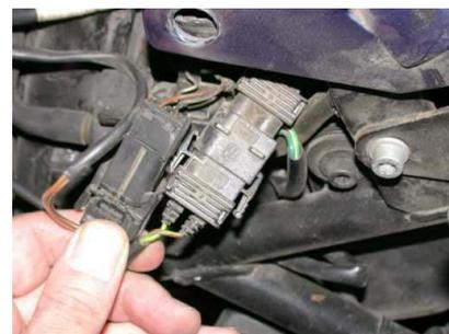
6. Connectez ensuite les différents fils au faisceau en utilisant les cosses spéciales épissures. Voir détails sur photo ci-dessous.
