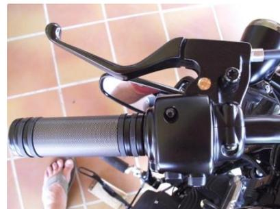
12. Positionner correctement la poignée sur le guidon en vérifiant que le rétroviseur ne vienne pas toucher le réservoir lorsque le guidon est en butée
