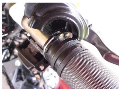
24. Mettre en place la nouvelle poignée sur le guidon et reconnecter les câbles de gaz dans leurs guides respectifs.
