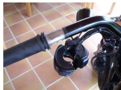
5. Enlever la poignée du guidon en essayant de la faire tourner pour la décoller. A ce stade on peut s'aider en mettant du lubrifiant entre la poignée et le guidon ou en soufflant de l'air comprimé.
