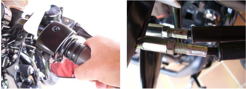
32. Mettre le moteur en marche et vérifier que la poignée de gaz fonctionne et revient correctement en place. Vérifier également en tournant le guidon de butée en butée qu'il n'y a pas de variation du régime moteur.
