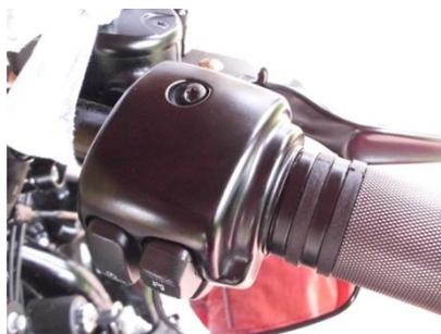
26. Remettre les 2 vis Torx 25 en place (Une dessus et une dessous) sans les serrer.
