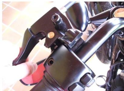
2. Retirer la bride et sortir la poignée. Laissez la pendre par le câble d'embrayage.
